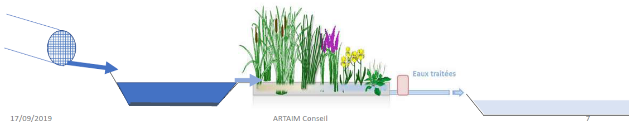
Figure 11 : Principe du traitement des eaux pluviales
