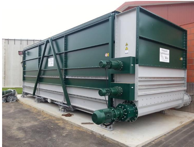
Figure 2 : Trémie de réception avec fond mouvant ; vis sans fin de transport (Source : EnviTec Biogas)
